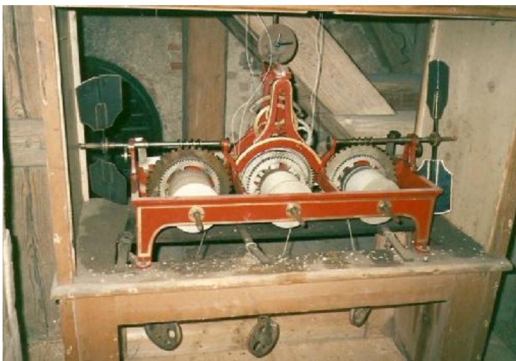
Dosud funkční hodinový stroj věžních hodin místního kostela
